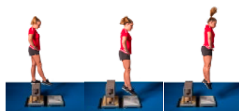
Abbildung 2: Reaktivkraftmessung auf der Kraftmessplatte bei einem Drop Jump.
